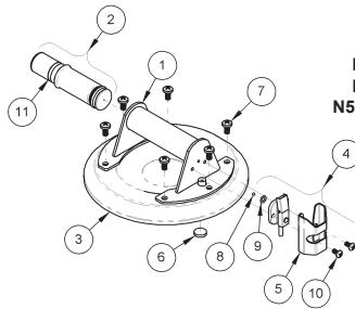
\* Reparatur-Satz 90504 für Sauger aus Metall (6, 8, 9 und Pumpenkolben-Schmiernmittel)
